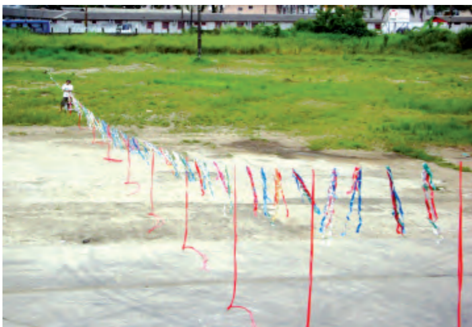
Figura 12: Modelo de Toriline misto (com fitas longas e curtas intercaladas), testado no Brasil em 2009 e incorporado pelo Uruguai como modelo padrão daquele país.
